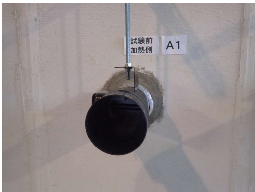
写真 1 試験前の加熱側の状況（試験体記号 A1）
