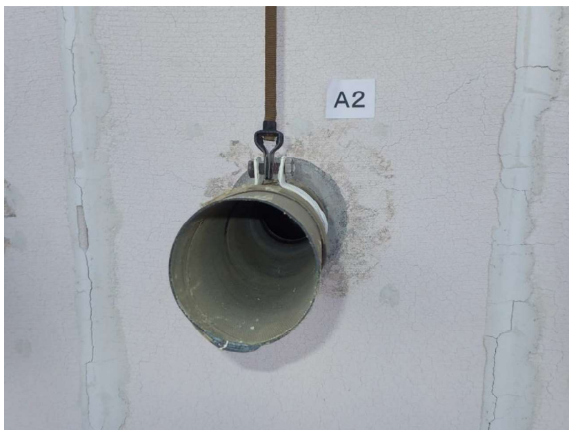
写真 7 試験後の加熱側の状況（試験体記号 A2）
