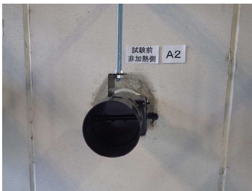
写真 6 試験前の非加熱側の状況（試験体記号 A2）
