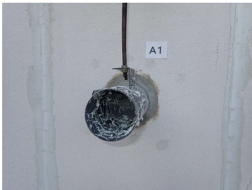
写真 3 試験後の加熱側の状況（試験体記号 A1）
