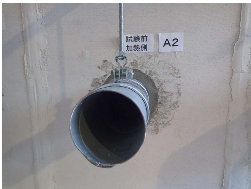
写真 5 試験前の加熱側の状況（試験体記号 A2）
