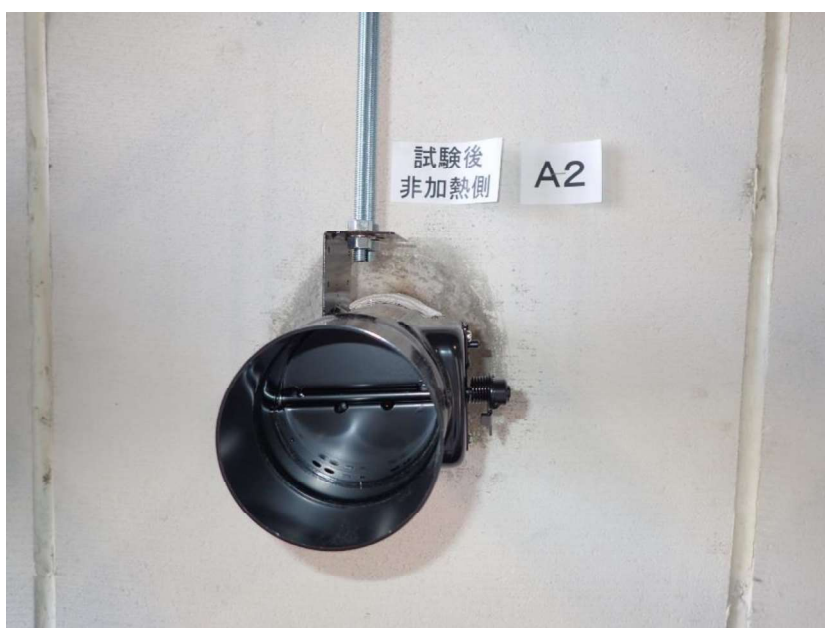
写真 8 試験後の非加熱側の状況（試験体記号 A2）
