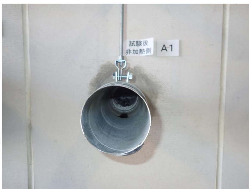
写真 4 試験後の非加熱側の状況（試験体記号 A1）
