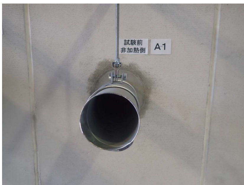
写真 2 試験前の非加熱側の状況（試験体記号 A1）
