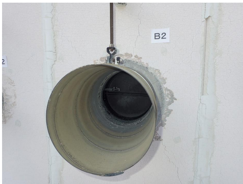
写真 7 試験後の加熱側の状況（試験体記号 B2）
