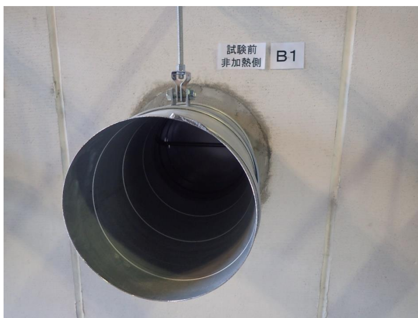
写真 2 試験前の非加熱側の状況（試験体記号 B1）
