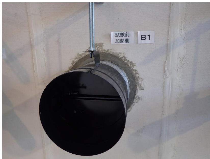
写真 1 試験前の加熱側の状況（試験体記号 B1）
