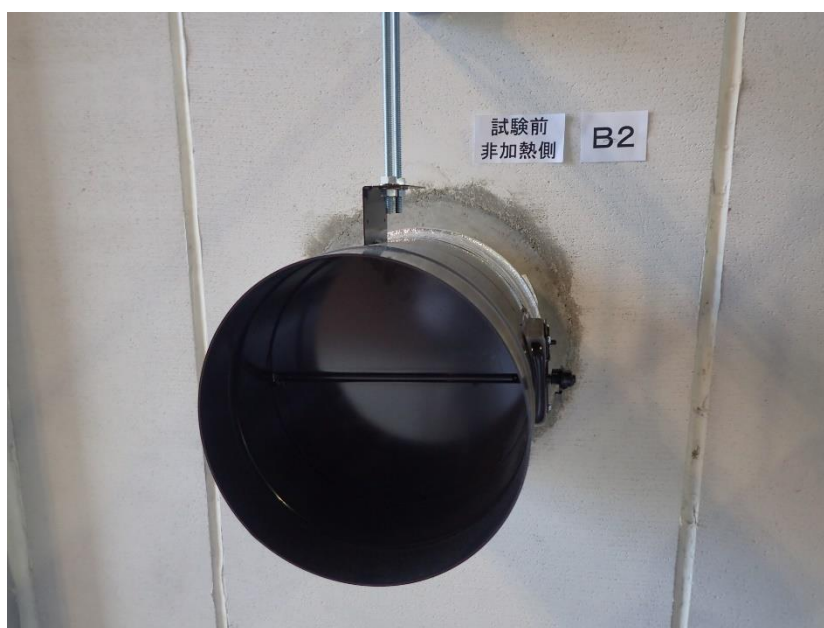
写真 6 試験前の非加熱側の状況（試験体記号 B2）
