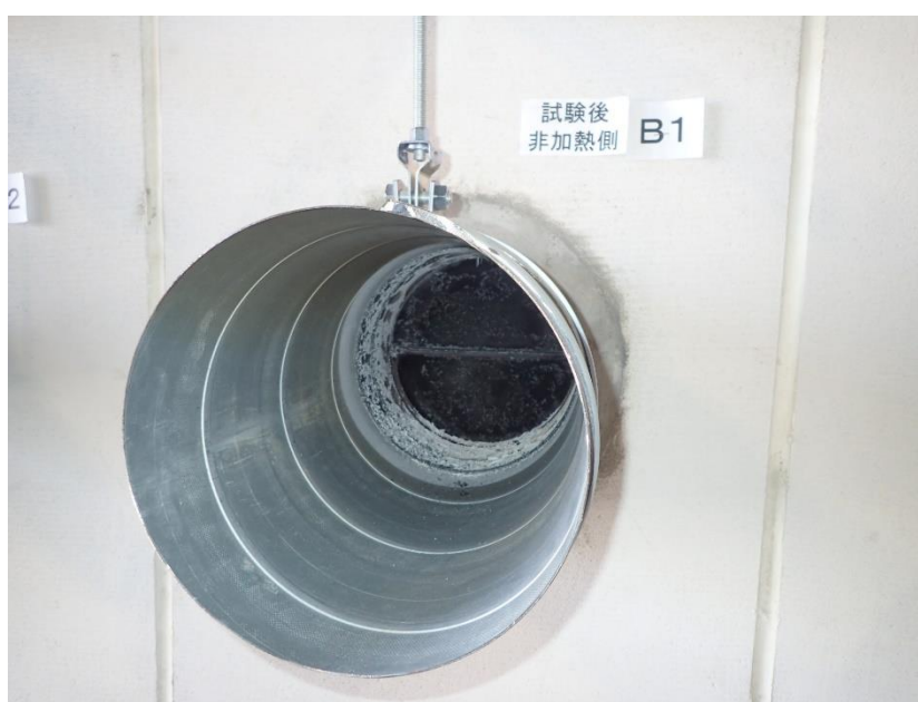
写真 4 試験後の非加熱側の状況（試験体記号 B1）
