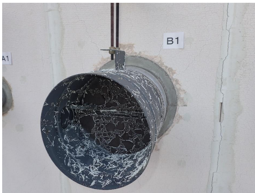
写真 3 試験後の加熱側の状況（試験体記号 B1）
