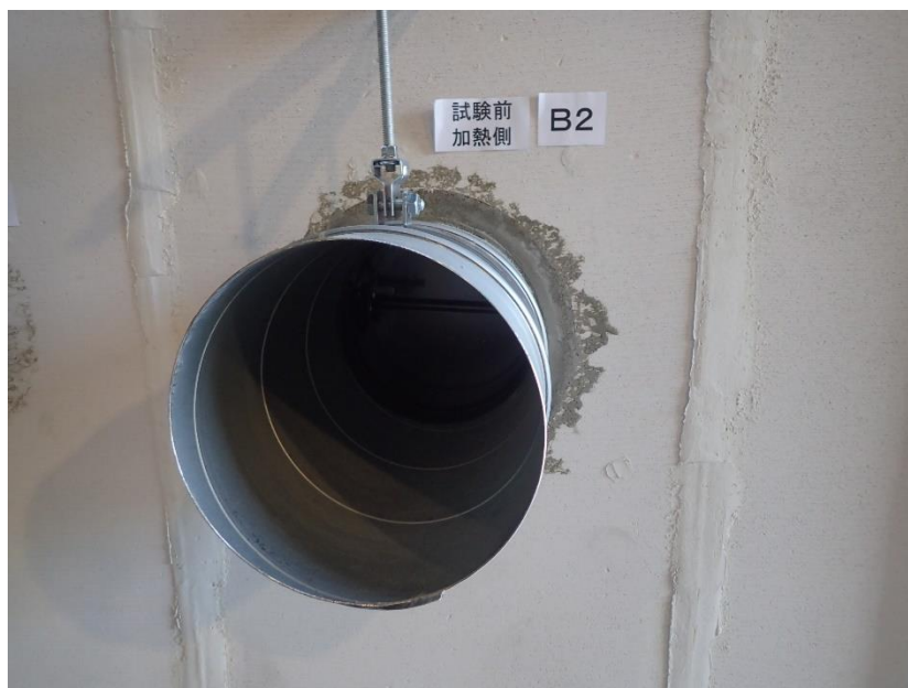
写真 5 試験前の加熱側の状況（試験体記号 B2）
