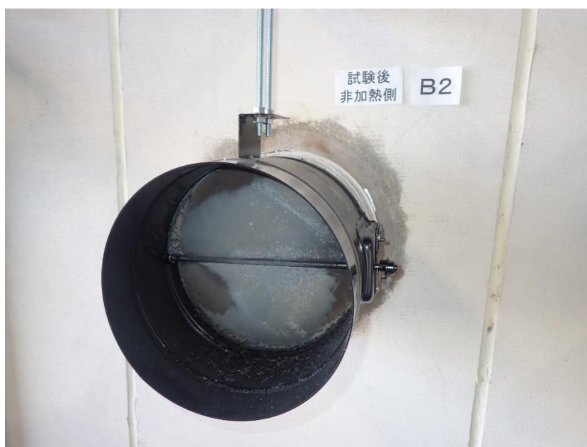
写真 8 試験後の非加熱側の状況（試験体記号 B2）
